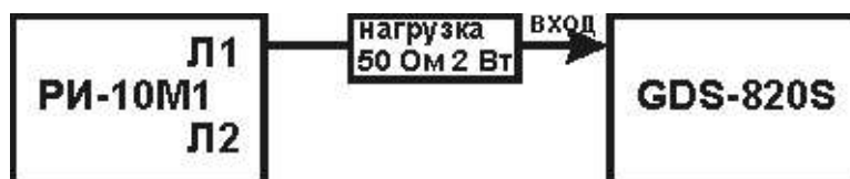
Рисунок 9-2 Схема проверки параметров зондирующего импульса
