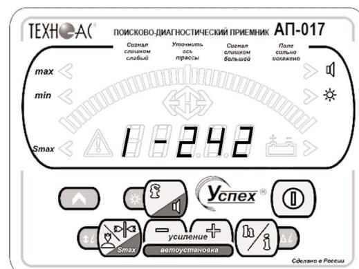
Также, процедура автоустановки усиления запускается автоматически при включении приёмника, изменении рабочей частоты и в некоторых других случаях.
