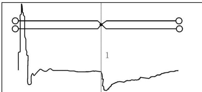
**Рисунок 6-2 Короткое замыкание**
