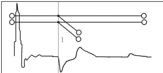
**Рисунок 6-4 Параллельный отвод**
